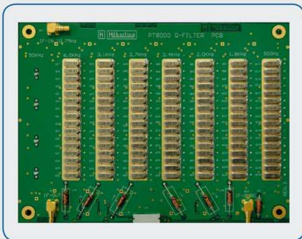
Diskret aufgebaute 16-pol. Quarzfilter
